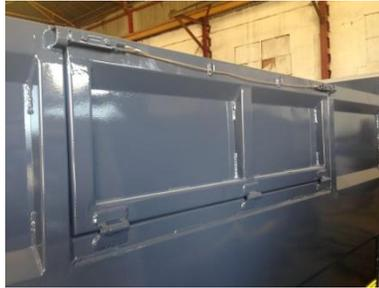
Compuerta para hacer trabajos de Boleo y/o recogida de R.S.U.
